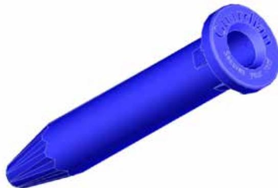
Пластиковая втулка телескопическая предназначена для механического крепления кровельной мембраны к несущему основанию через слой утеплителя. Используется совместно с Шайбой Центрикс. Длина втулки зависит от толщины слоя утеплителя и должна быть меньше его на 10-15%. Пластиковый крепеж отличается надежностью и устойчивостью к атмосферным воздействиям, а также способствует уменьшению потерь тепла.
